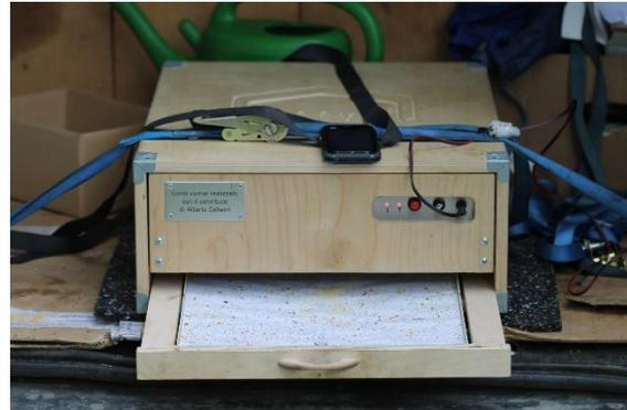
Abbildung 37. BeeVS® Varroa-Zähler von Apisfero im Betrieb am Bienenstand.
